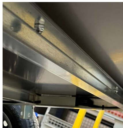
Ni rivet, ni vis autoperforante! Plancher fixé avec des vis inox et des écrous frein pour permettre une meilleure solidarité entre ce dernier et le châssis.
