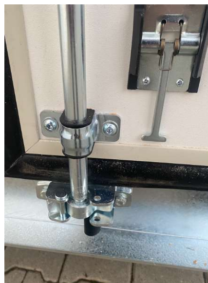
Arrêts de portes partie sur la porte
