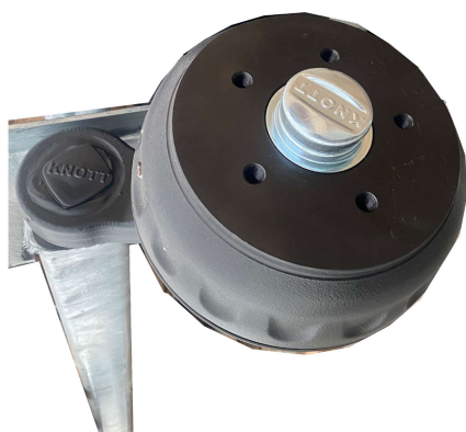
Essieu KNOTT 1350 kg avec freins.
