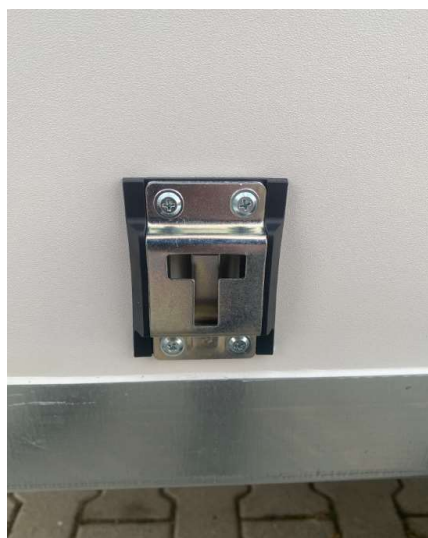
Arrêts de portes, partie sur la carrosserie pour éviter les battements au vent lors d'un chargement.
