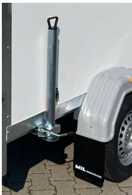
2 Béquilles coulissantes avec collier de blocage. Bavettes de roue anti projection.
